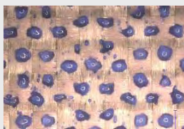
ガラスクロスDot®のマイクロSCOPE画像 紫色が熱可塑性樹脂のドット (撮影のために樹脂を染めている)
